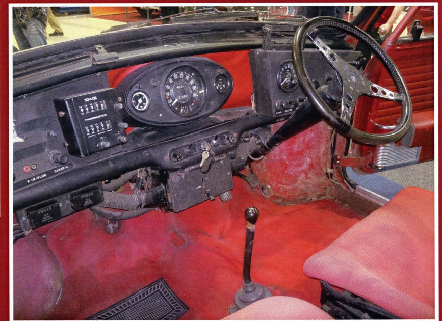
Hienoja yksityiskohtia Abingdonin rallitehtaan jäljiltä. Jalkasuojat ovipaneeleissa, alkuperäiset 60-luvun turvavyöt ja penkit, mittaristopaneelin lukuisat kytkimet ja varoitusvalot. Kaikki alkuperäisiä osia auton kilpahistorian alkutaipaleelta saakka.
