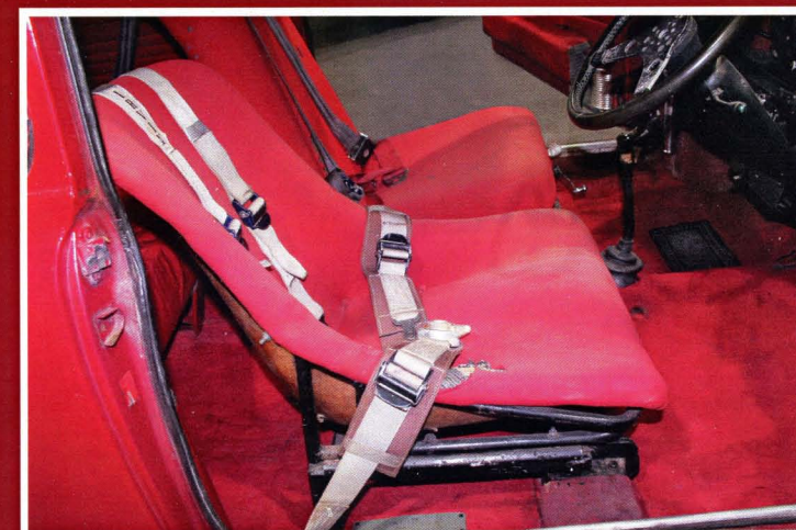
Hienoja yksityiskohtia Abingdonin rallitehtaan jäljiltä. Jalkasuojat ovipaneeleissa, alkuperäiset 60-luvun turvavyöt ja penkit, mittaristopaneelin lukuisat kytkimet ja varoitusvalot. Kaikki alkuperäisiä osia auton kilpahistorian alkutaipaleelta saakka.
