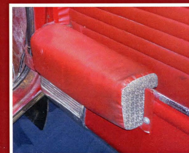
Hienoja yksityiskohtia Abingdonin rallitehtaan jäljiltä. Jalkasuojat ovipaneeleissa, alkuperäiset 60-luvun turvavyöt ja penkit, mittaristopaneelin lukuisat kytkimet ja varoitusvalot. Kaikki alkuperäisiä osia auton kilpahistorian alkutaipaleelta saakka.
