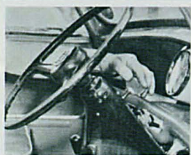
MOLEMPIEN pöiden ohjauksipöivöissä on avaimelta käytettävä kytkin. Sen mukaan, kumpi pää johtaa, tejetään toinen pää tska-akselliksi ja pyörät kääntymättömiksi. Samalla ohjautuu vetojärjestelmä.
