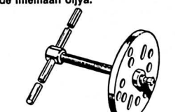
Erikoistyökalu vauhtipyörän irrotukseen. Vastaavan työkalun voi valmistaa itsekin. Irrotustyötä helpottaa, jos keskiruuvien päähän mojutellaan lekalla aina ruuvien kiristämisen välillä.
