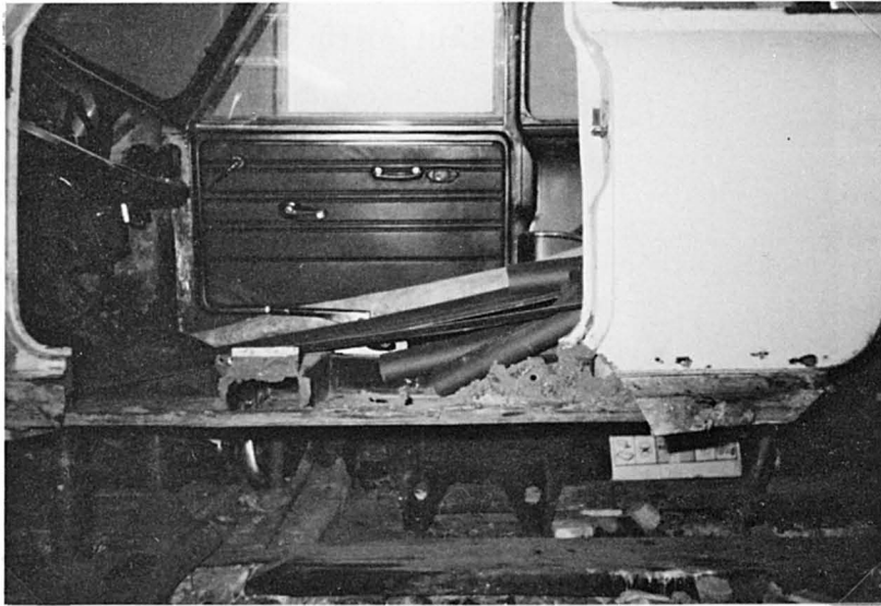
Kuva 1. Minin vasemman puoleinen helma "pintaruosteen irtikopistelun" jälkeen.
