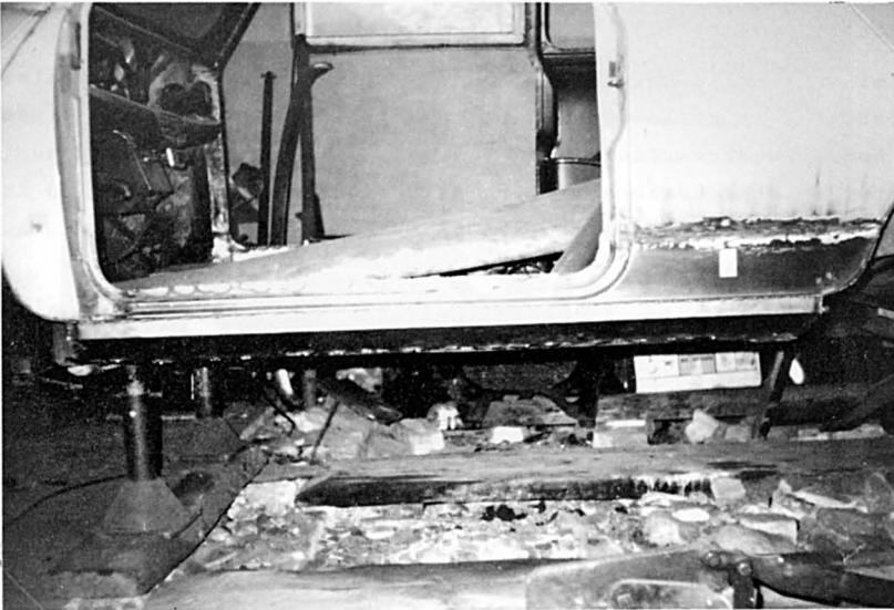
Kuva 2. Sama helma n. 10 tunnin työrupeaman jälkeen. Seuraavana vaiheena pääsin vasta aloittamaan varsinaiset "rakennustyöt". Turvakaarien kiinnityskohtiin hitsasin 3mm levyä vahvikepalat sääntöjen mukaisesti. Pääkaaren kiinnityspiste on oven
