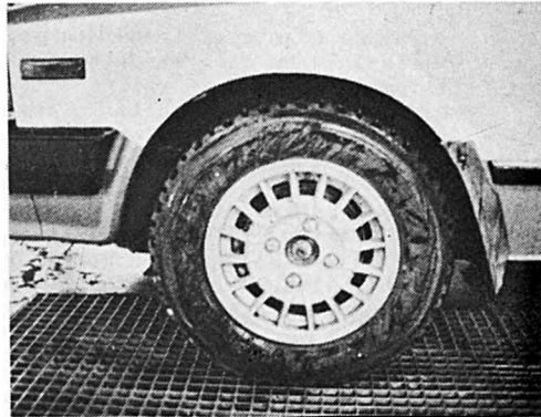
Lokasuojalevikkeiksi ei riitä kumisen läpän reuna eikä toisaalta teräväreunainen pelti, joka on koristeellista peitetty. Levikkeessä tulee olla 3 cm "hiekkapelti", jota vastaavia näkee normaaliokasuojankin reunoina.
