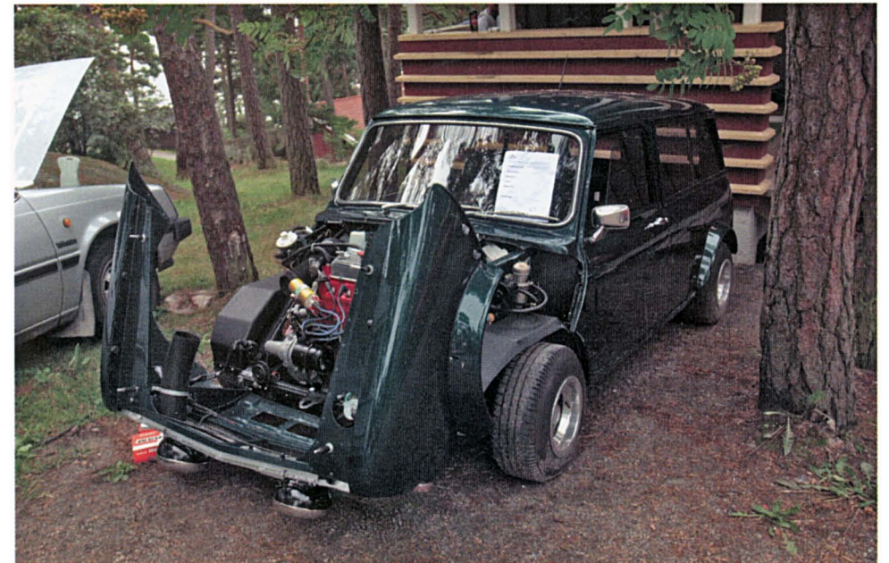
Pari eri versiota flippikeulasta. Huoltotoimet ovat todella helpot, kun koko moottorin saa kunnolla näkyviin.
